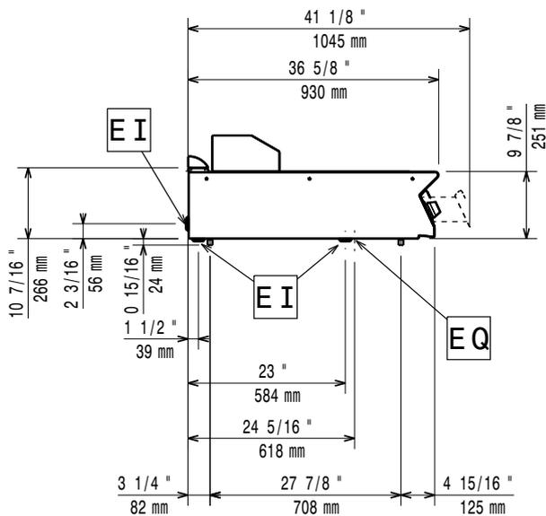
EI = Conexión eléctrica (energía)
